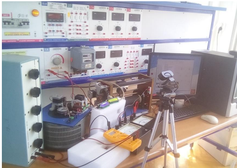
Rysunek 1. Stanowisko pomiarowe podczas realizacji ćwiczenia laboratoryjnego z Elektrotechniki Szeregowe obwody RLC wykorzystujące odbiorniki sterowne za pomocą mikrokontrolerów podłączonych do komputera PC, na którym uruchomiono dedykowane oprogramowanie umożliwiające zmianę parametrów w obwodzie pomiarowym. Oprac. G. Kopeć i zespół.
