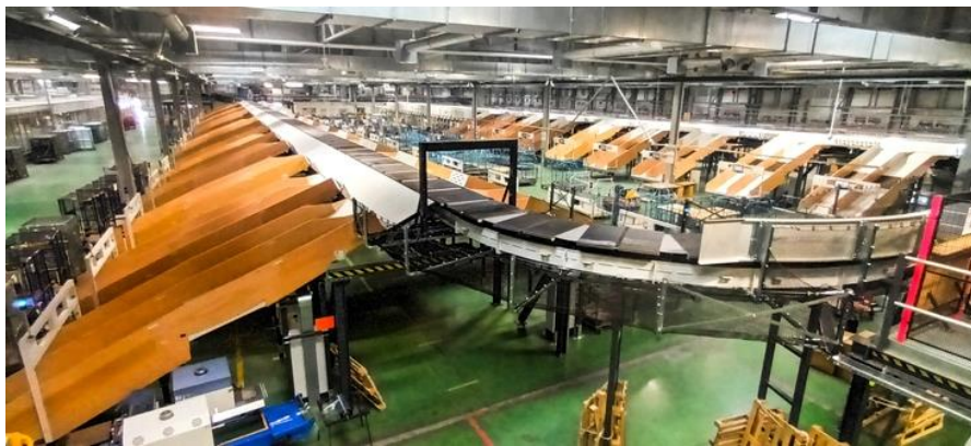
Rysunek 3. Na rysunku przedstawiono sorter paczkowy automatyczny, Poczta Polska [11], source:(2023.11.12) https://pap-mediaroom.pl/biznes-i-finanse/poczta-polska-uruchomila-sorter-paczkowy-w-lubelskiej-sortowni
